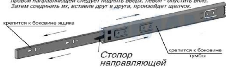
Рис.4 Схема установки шариковых направляющих
